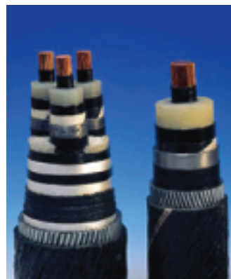
■ A la izquierda, cable XLPE trifásico y monofásico. En el centro, cable PPLP. A la derecha, cable extruido VSC.
